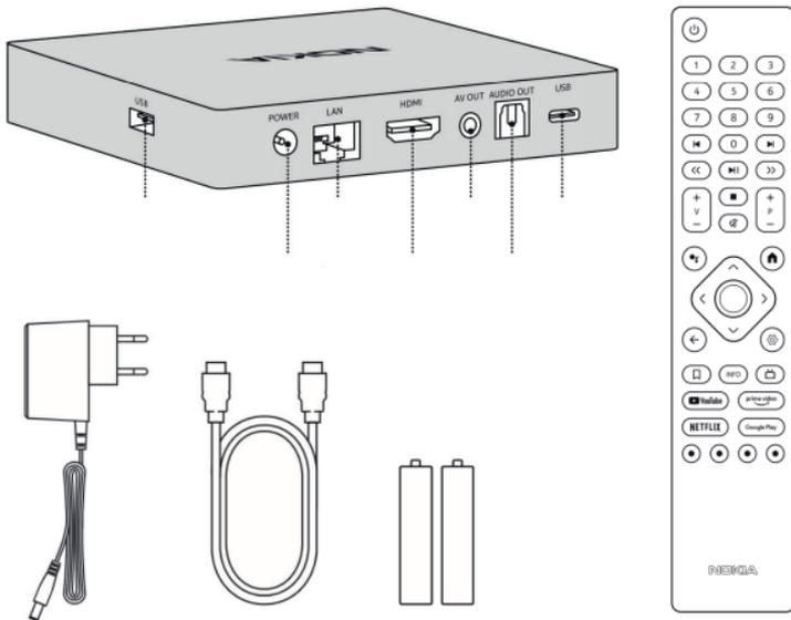
2. Verbinden Sie nun das HDMI-Kabel mit der Set-Top-Box und Ihrem Fernseher. Anschließend öffnen Sie die Klappe auf der Rückseite der Fernbedienung und legen die Batterien ein.
