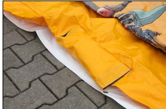
14. **Luftzufüllschlauch über das Gebläserohr stülpen** und mit dem Schnallenband **festmachen**. Überprüfen Sie, ob der Luftzufüllschlauch fest verschlossen ist. Erst dann darf das Gebläse gestartet werden. Bitte beachten Sie, dass der **Schlauch zum Aufblasen nicht geknickt** sein darf.
