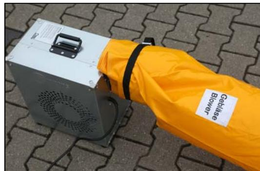
Das Gebläse an eine 220V/16A Steckdose anschließen. Während des gesamten Hüpfburgbetriebs das Gebläse laufen lassen.
